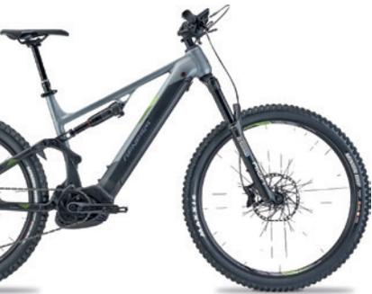
Die neue Rahmengeometrie mit 29" Laufrad an der Front und 27,5" Laufrad mit Plus-Bereifung im Heck des **GENESIS E-VO FS MTB 2.3** verleiht diesem 150 mm Fully beste Eigenschaften wie Lenkpräzision und Traction im Uphill, als auch bergab. Schaltung: Shimano Deore XT Shadow Plus Antrieb: Bosch Performance CX Line Gen. 4
